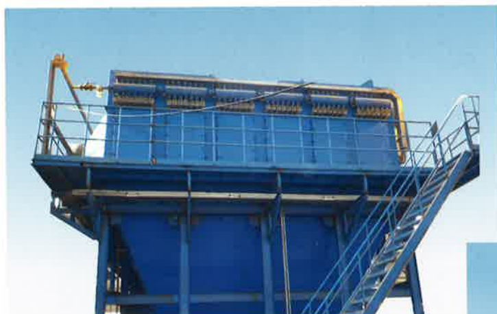
製鐵所環境集塵（中国） 処理風量：1500m 3 /min
